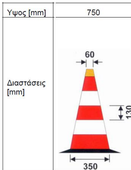
Εικόνα 10– Διαστάσεις κυκλοφοριακών κώνων
